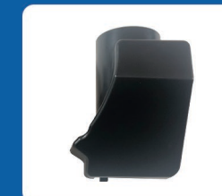
> Lateral Air Ducts داکت های بخاری
