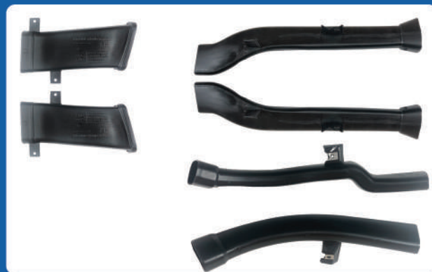
> CONSOLE AIR DUCTS داکت های کنسول
